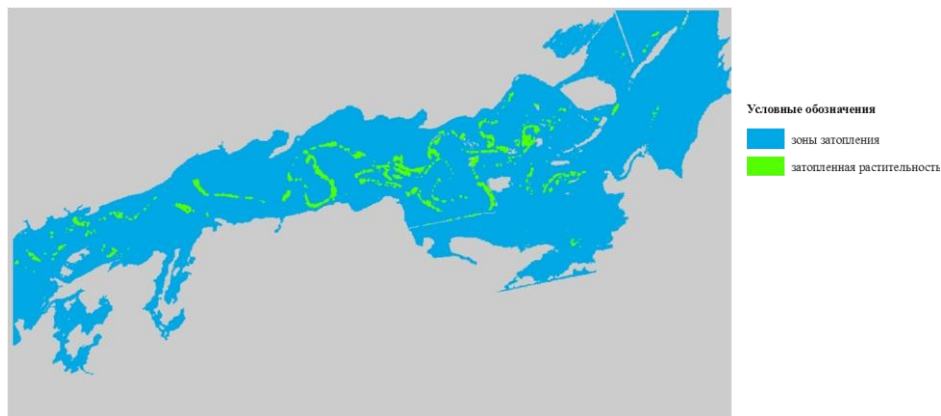
Рис. 3. Комбинированная маска воды, полученная при слиянии радарных данных Sentinel-1 и оптических Sentinel-2 за 1 мая 2017 года
