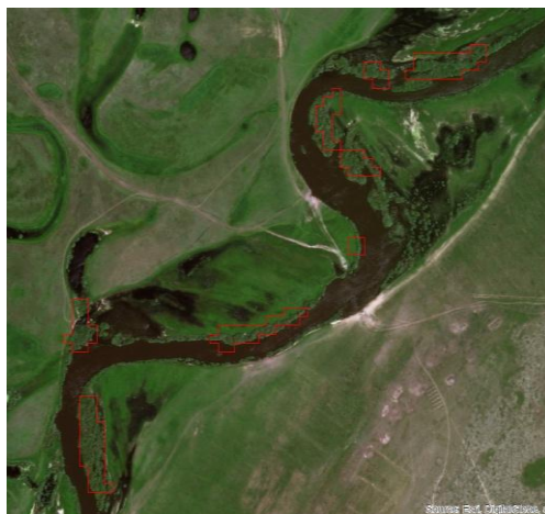
Рис.4. Вектор затопленной растительности, полученный в результате синтеза радарных и оптических данных за 1 мая 2017 года фрагмента полигона Гастелло, наложенный красным цветом на космоснимок высокого разрешения
