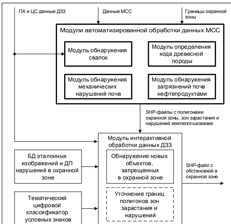
Рис. 1. Структура программного обеспечения автоматизированного оценивания состояния охранной зоны ЛЭП по данным ДЗЗ
