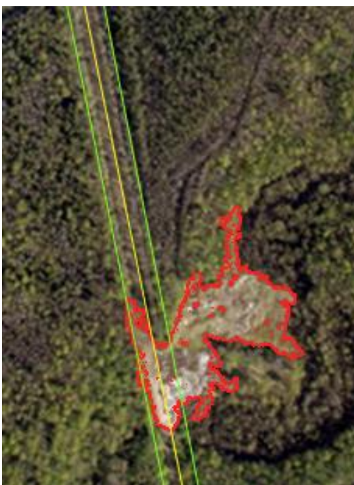
Рис. 3. Обнаружение несанкционированной свалки в пределах охранной зоны ЛЭП
