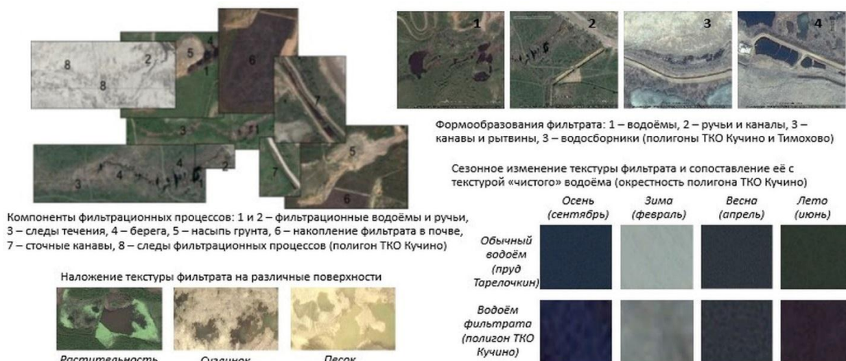
Рис. 5. Визуальные признаки фильтрационных процессов на свалках: а) фотографии; б) спутниковые изображения фильтрата [Google Earth]
