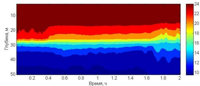
Изменчивость температурной структуры водной толщи при проходе фронта с 11:00 до 13:00 18 сентября. Сначала термоклин расширился, а затем сразу после прохождения полосы пены по термоклину пошли волны высотой 5 м и периодом 10 мин с признаками принадлежности ко 2-ой моде.
