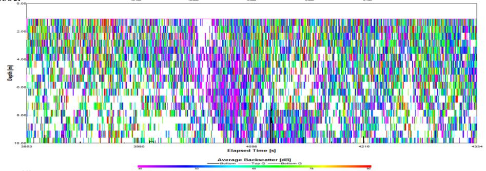
Данные ADCP по вертикальной компоненте течений (вверху) и обратно рассеянному сигналу (внизу) в момент прохождения под эстакадой полосы пены. Видно, что приповерхностные пузырьки затаскиваются вниз вертикальным течением величиной около 10 см/с, сопровождающим проходящий фронт.
