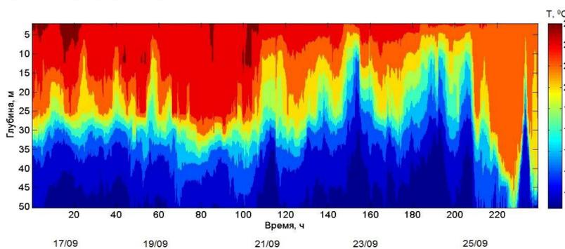
Временной ход температуры водной толщи за весь период наблюдений. В колебаниях температуры хорошо прослеживаются инерционные внутренние волны (период 17 ч) высотой 10 м и более.
