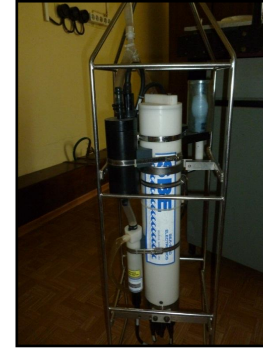
Рис. 2. Погружной профилограф. Датчики: температура, ФАР, флуоресценция (РОВ, Хлорофилл-а)
