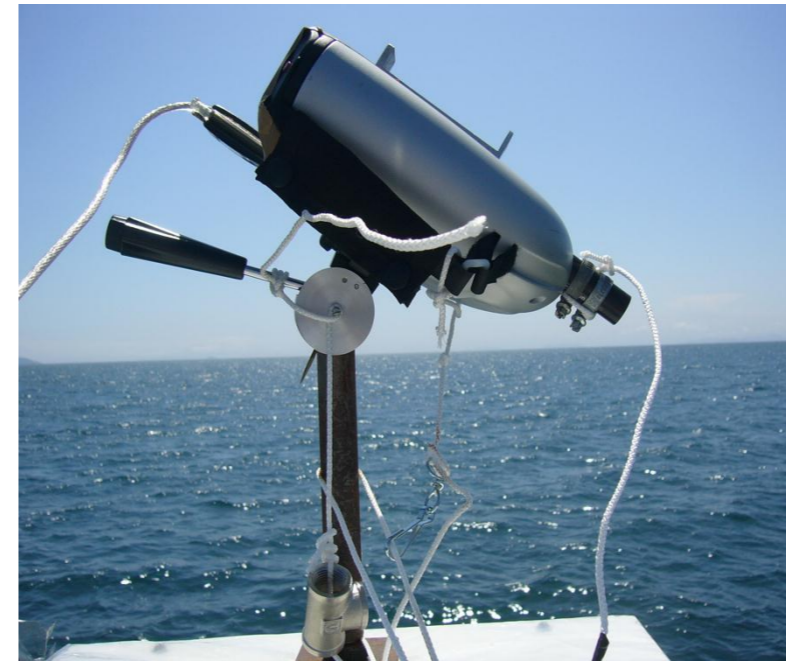
Рис. 1. Портативный спектрометр ASD FieldSpec Hand Held. Диапазон 325-1075 нм., разрешение 1 нм.
