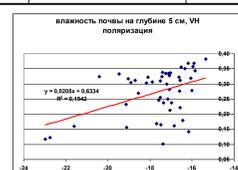
Регрессионное соотношение между  $\sigma_{VV}^0$  [дБ] и влажностью почвы на глубине 5 см T<sup>0</sup> для станции Gevenich (Германия)
