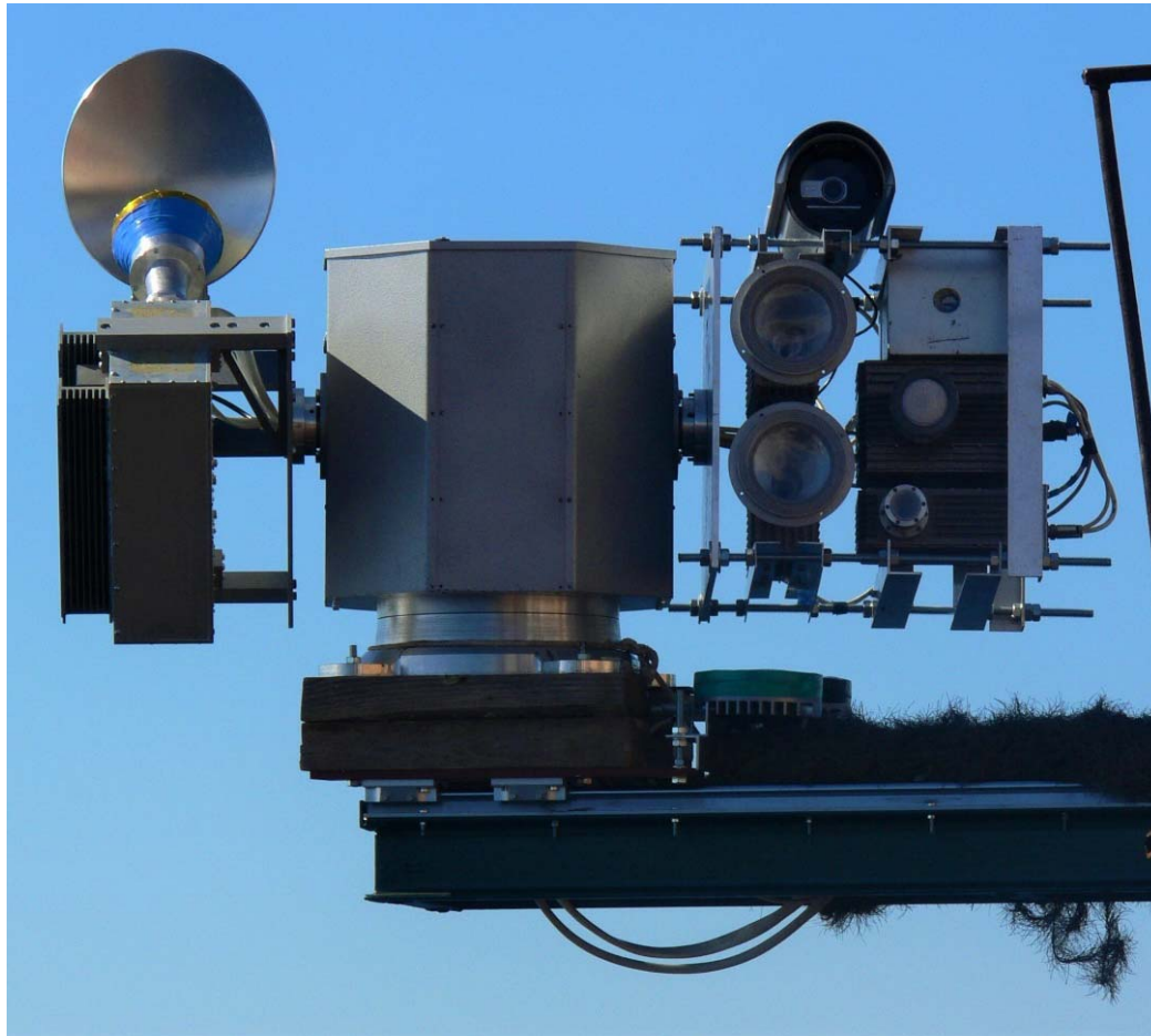
Поворотно-сканирующая платформа "Траверс-2".
