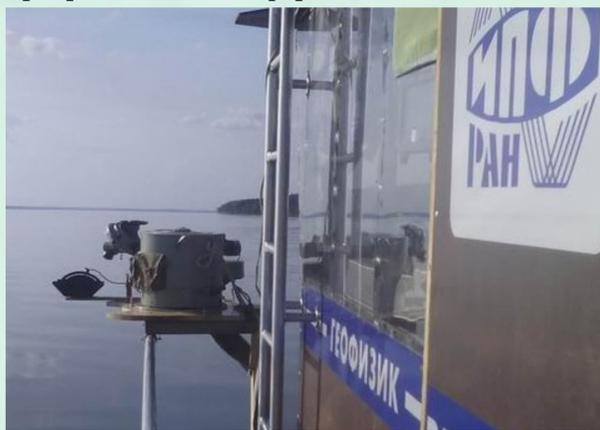
Измерения КЯ воды осуществлялись спектрофотометром, разработанным в отделе оптики моря МГИ РАН. КЯ определяется с шагом 1 нм и с погрешностью в среднем по спектру 3%. Для компенсации отраженной компоненты измеряются спектры восходящего излучения тонкого слоя воды в кювете с поглощающими стенками и дном. Для вычисления КЯ восходящая яркость тонкого слоя воды вычитается из яркости водоема, результат делится на яркость белого экрана.
