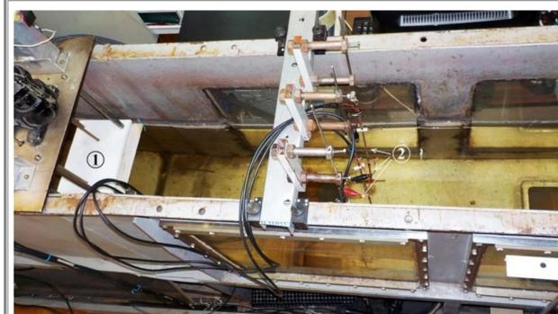
Исследования проводились в бассейне с размерами 240×29×29 см заполненном водой, на поверхность которой наносилось определённое количество плёнки OLE (олеиновая кислота). Далее возбуждали волны разной амплитуды с помощью волнопродуктора (1). Также мерилась амплитуда и частота волн с помощью волнографов (2).
