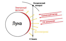
Рис. 5. Негативный заряд лунной поверхности токами Биркеланда приводит к выносу фотоэлектронов в атмосферу Луны.
