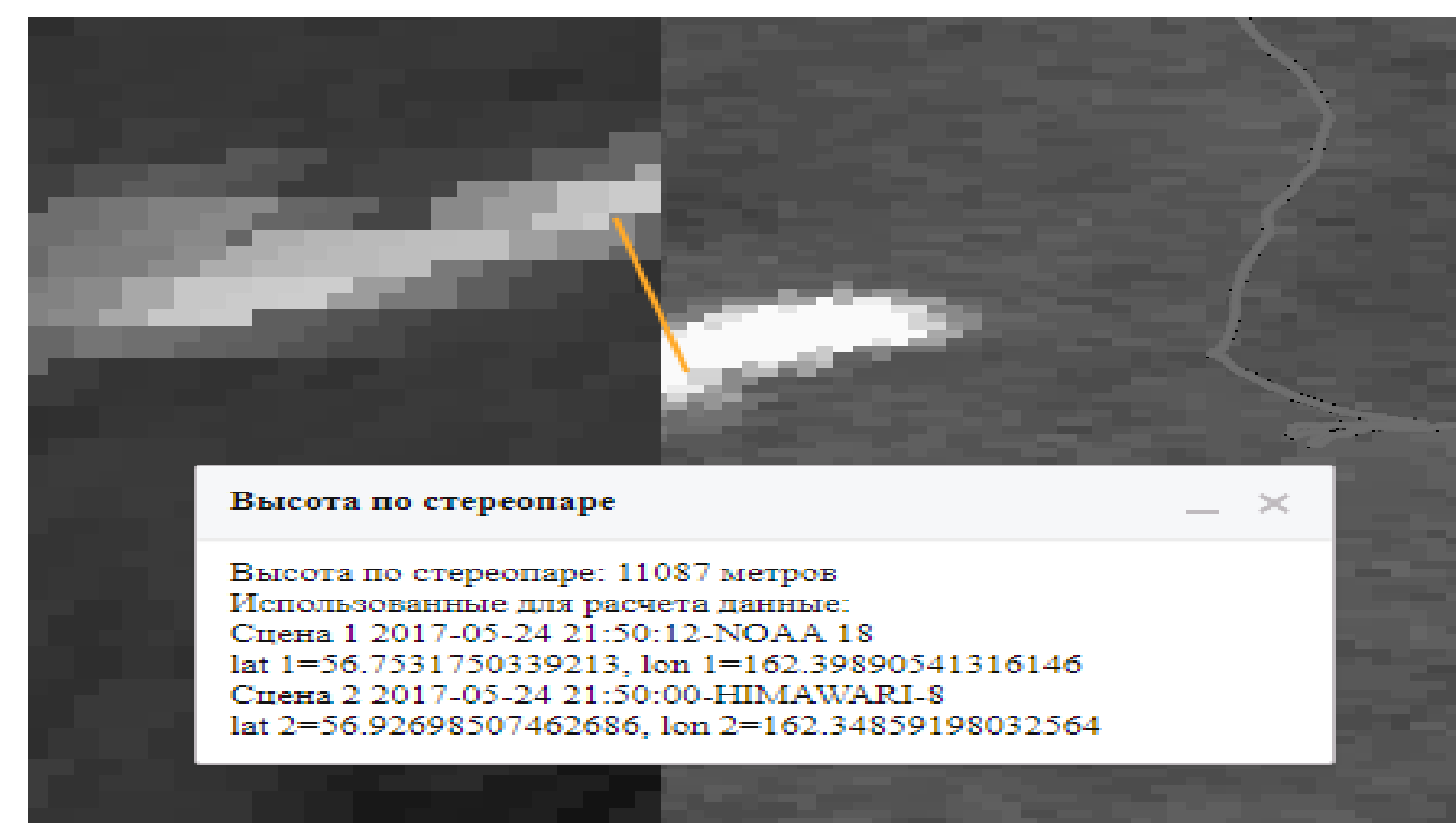
Пример вычисления высоты верхней границы пеплового облака по «стереопаре»
