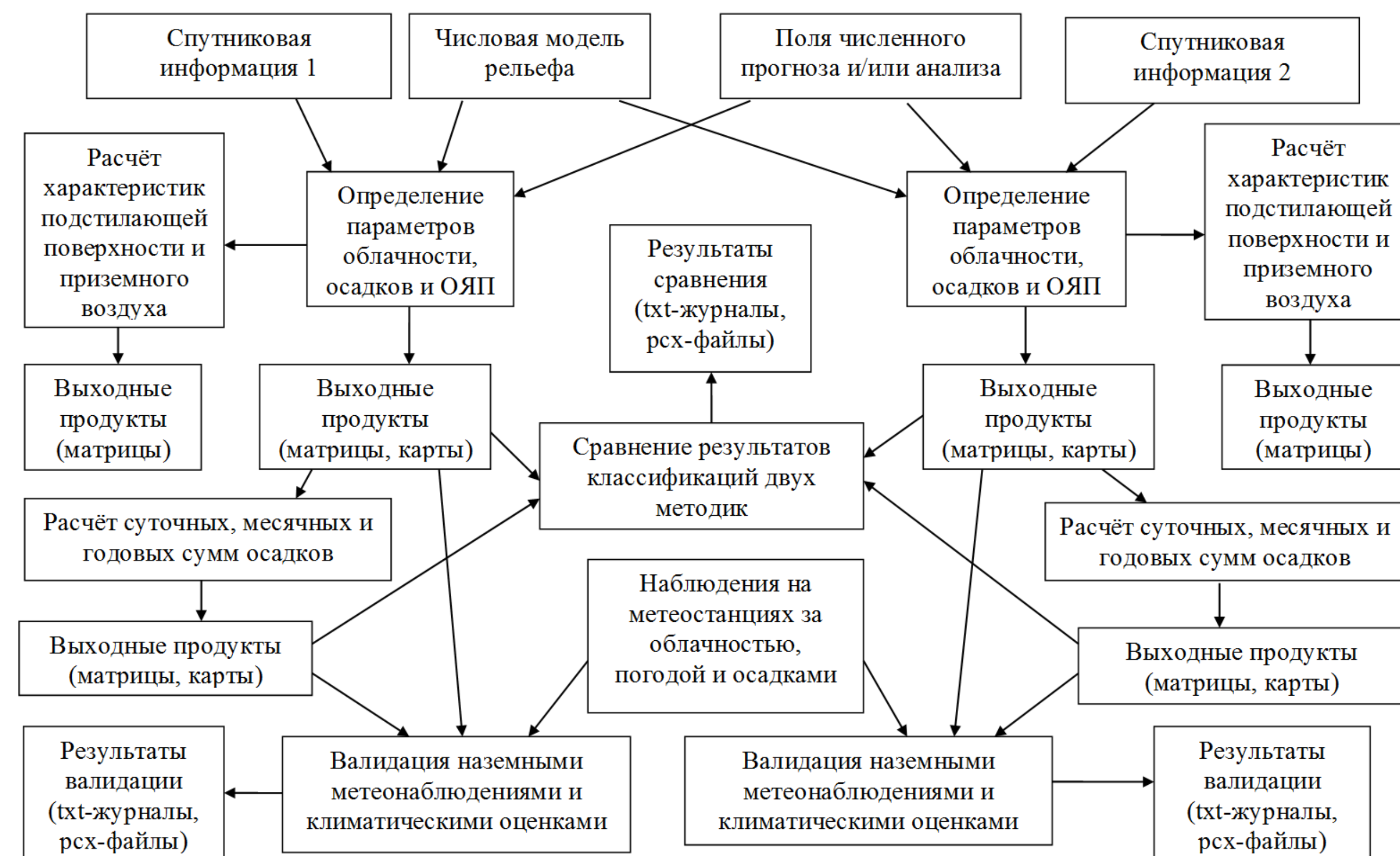
Рис. 1. Краткая структура СПК «ETP» классификации и валидации для двух видов спутниковой информации.
