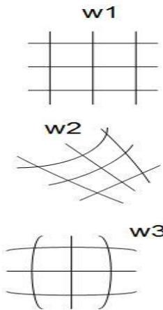
Нанесение 2D-сетки на двухмерное пространство (плоские искажения)
