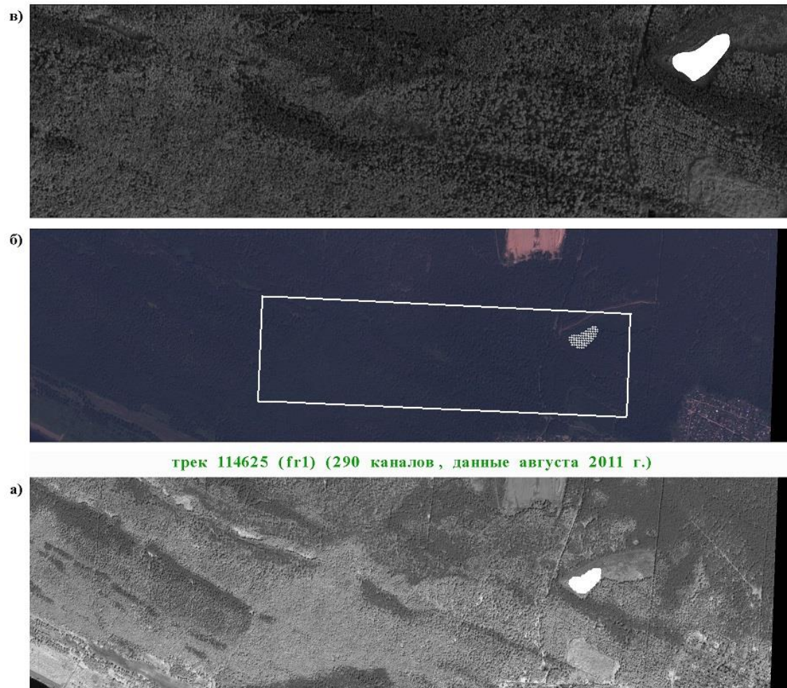
Рис. 16. Отображение выбранных ранее эталонных участков типов поверхности самолетной съемки на спутниковую систему координат: в) оцифрованный ранее участок фрагмента самолетного трека, б) автоматический перенос контура участка через GPS геопривязку на спутниковую систему координат, а) автоматическая оцифровка спутниковых спектров в пределах контура.
