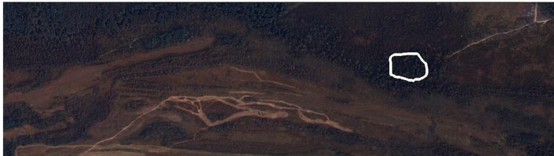
Рис. 6. Изображены автоматически оцифрованные системой по выбранному участку, обведенному контуром, с фрагмента рис. 4 и осредненные по этому участку функции спектральной яркости с представлением дисперсий. Участок соответствует еловому типу лесной поверхности и содержит 9294 спектра.
