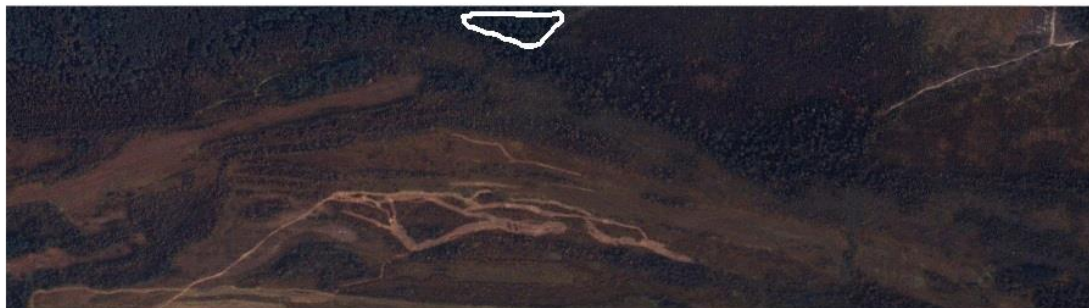
Рис. 5. Изображены автоматически оцифрованные системой по выбранному участку, обведенному контуром, с фрагмента рис. 4 и осредненные по этому участку функции спектральной яркости с представлением дисперсий. Участок соответствует сосновому типу лесной поверхности и содержит 6536 спектров.
