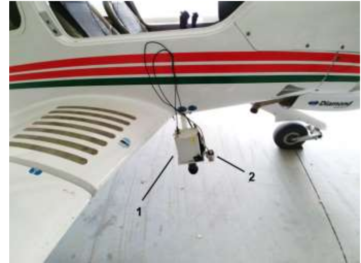
Спектрометр ФСР-02 с обзорной фотокамерой, установленные на борту самолета Diamond DA40NG: 1 – спектрометр ФСР-02 ; 2 – обзорная фотокамера.
