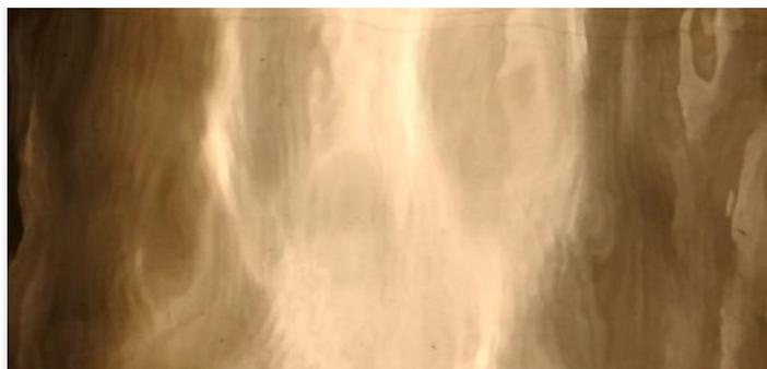
Ветровые волны, большой разгону Скорость ветра – 2м/с, фото сверху, подсветка - точечный источник. Видны гребни дм волн и брэгговская рябь на переднем и заднем склонах.
