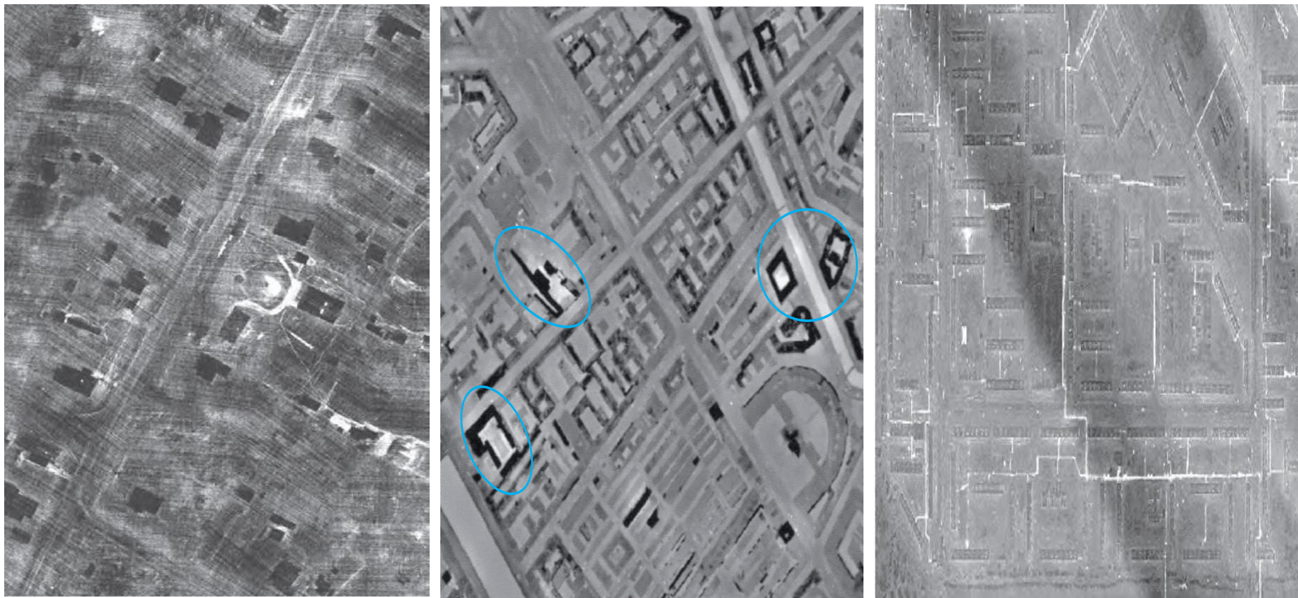
Рис. Проявление радиометрических искажений: структурного шума (слева), искажений в результате работы системы АРУ (в центре), помехи от системы внутренней калибровки (справа)
