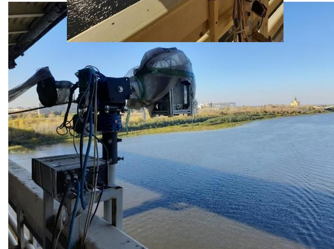
Рис.3. Радиолокатор №1 (сверху) «смотрящий» вверх по течению и радиолокатор 2 (снизу) направленный вниз по течению.
