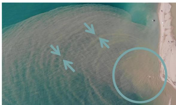
Рис. 7 Подповерхностные волны (стрелки), образованной грибовидной структурой и место их образование (круг)
