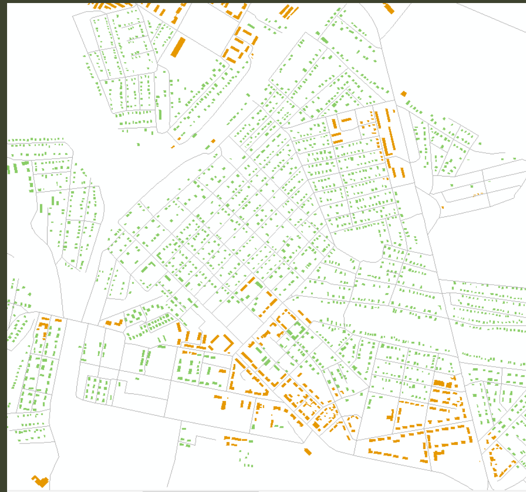
Новошахтинск. Оранжевым отмечены здания, экспортированные из OSM, зеленым – здания, оцифрованные по современному космическому снимку
