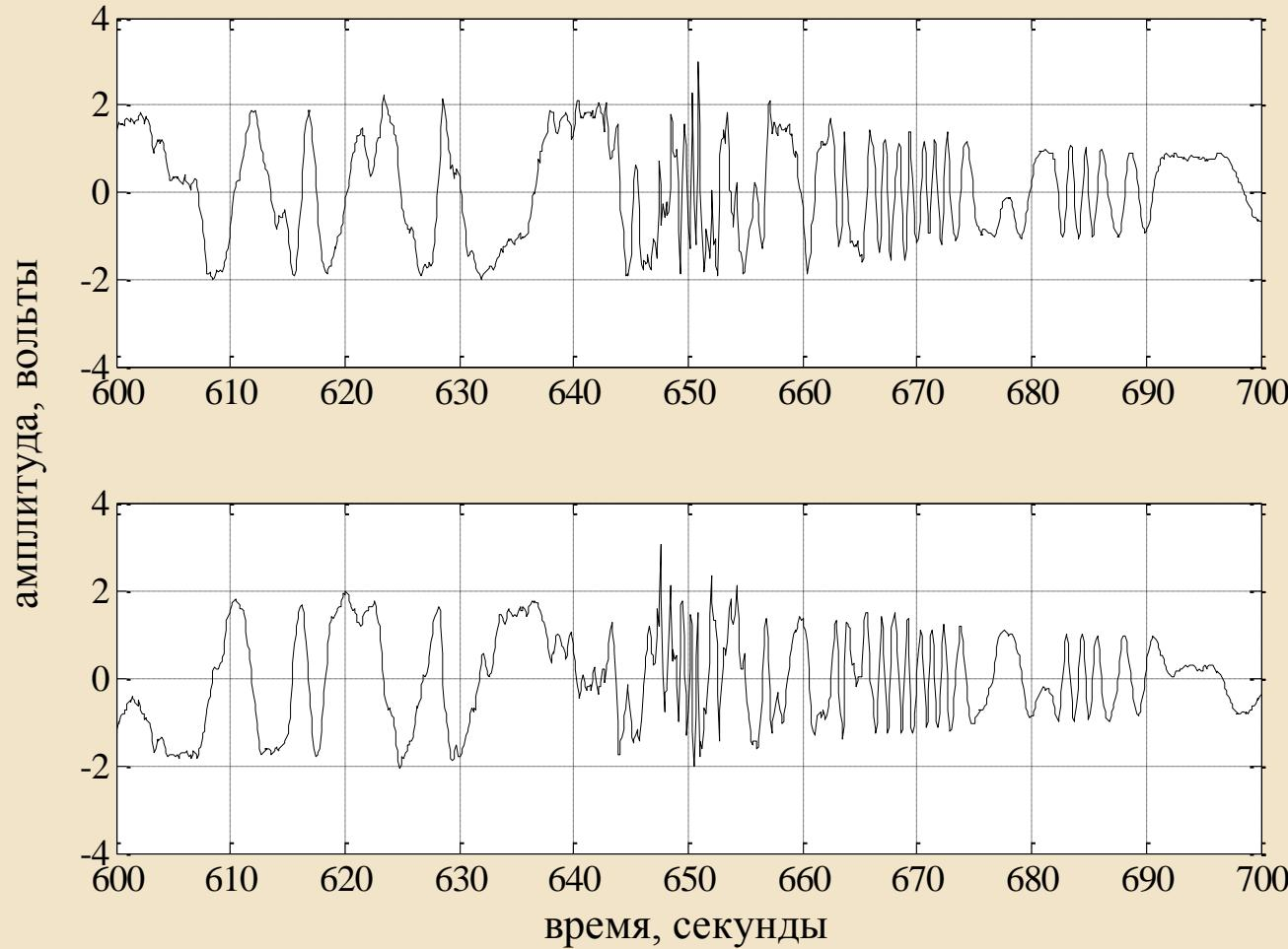
Участок записи квадратур первичного радиосигнала на частоте  $\sim 150$  МГц, содержащий флюктуации амплитуды с наибольшей интенсивностью с  $\sim 640$  с по  $\sim 660$  с.
