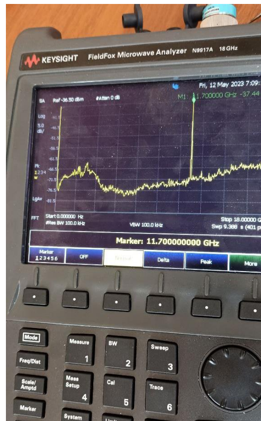
Рисунок 21 – Спектр сигнала на выходе СВЧ-тракта (выход ПЧ СВЧ-смесителя)
