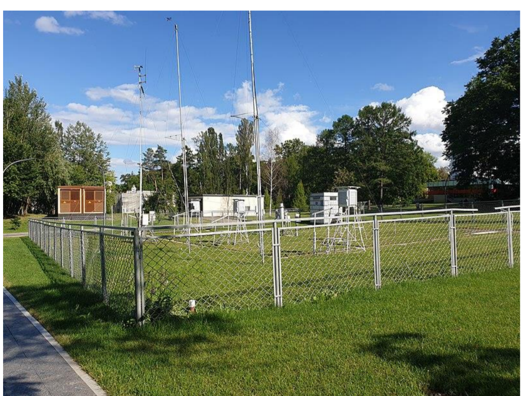
Рис.4. Вид на метеостанцию ВДНХ (Москва) 7 июля 2019 г. (направление съемки - юго-восток). Оборудование для измерения ветра установлено на мачте высотой 10 метров.
