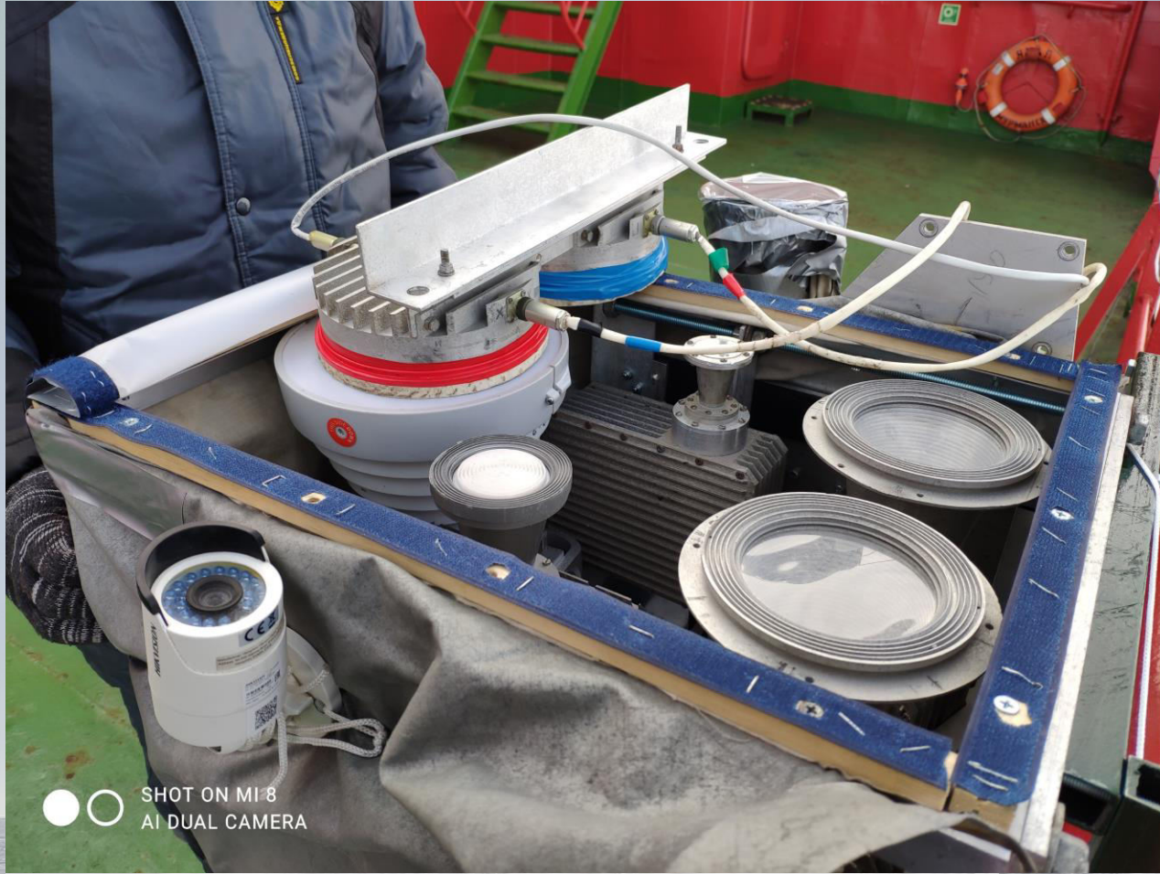
Калибровка по «горячей» и «холодной» согласованным нагрузкам
