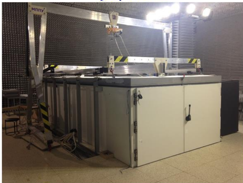
Сегмент АФАР на поворотном устройстве
