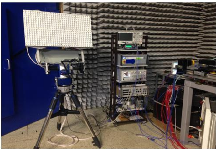
Сегмент АФАР на поворотном устройстве
