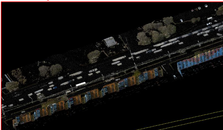
Фильтрация надземной части облака точек
